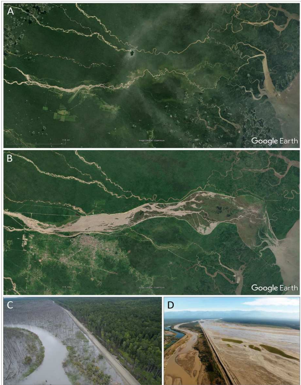
Figure 24 : Métamorphose fluviale de la rivière Ajkwa entre 1984 (A) et 2022 (B), inhérente aux activités minières sur la mine de Grasberg (Indonésie). La mine procède annuellement au déversement de plus de 80 Mt de résidus miniers. Le sur-engravement par les résidus miniers a un impact direct sur les milieux riverains. Cet impact s'est traduit par la disparition (enfouissement, dépérissement) de 138 km 2 de ripisylve et de forêt alluviale (C - © AEER) et par la mise en place d'une vaste zone de dépôt qui devrait, à terme, s'étendre sur 220 km 2 (D - © Freeport).
