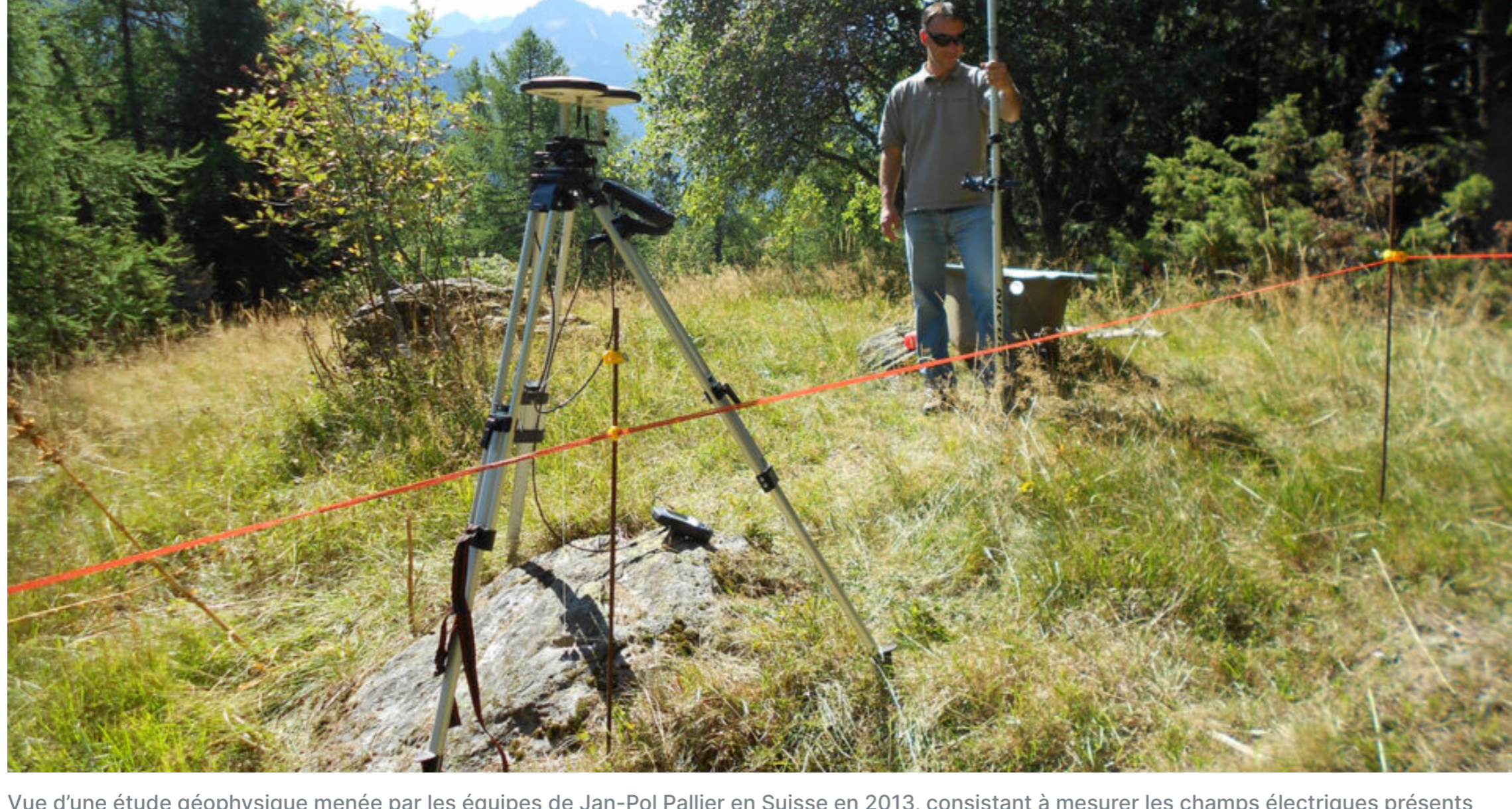
Vue d'une étude géophysique menée par les équipes de Jan-Pol Pallier en Suisse en 2013, consistant à mesurer les champs électriques présents dans les sols pour détecter la présence de métaux. (©Aurania Ressources)
