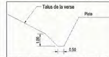
Figure 10 : Coupe type du fossé extérieur de collecte
