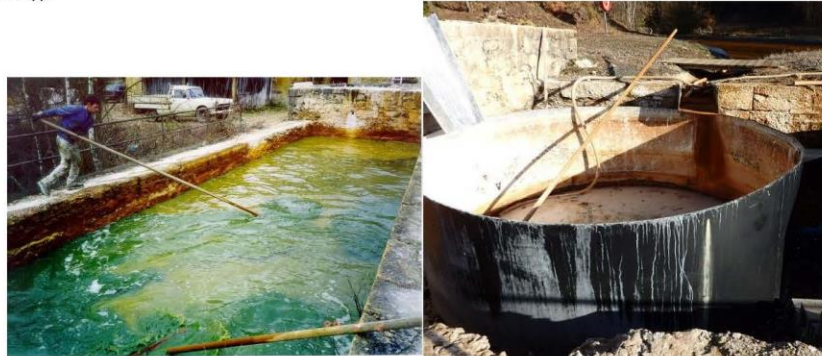
Figure 7 : Cuve de traitement "de secours" avec l'agitateur et brassage manuel réalisé sur le site de Chessy avant (photo de gauche) et après 2003 (photo de droite)
