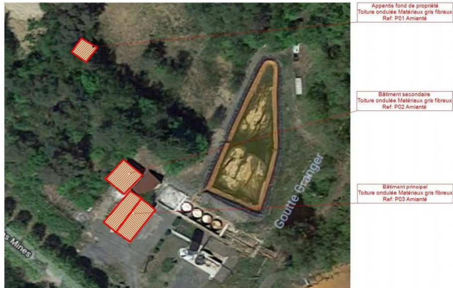
Figure 11 : Localisation des matériaux amiantés mis en évidence par le diagnostic « amiante »
