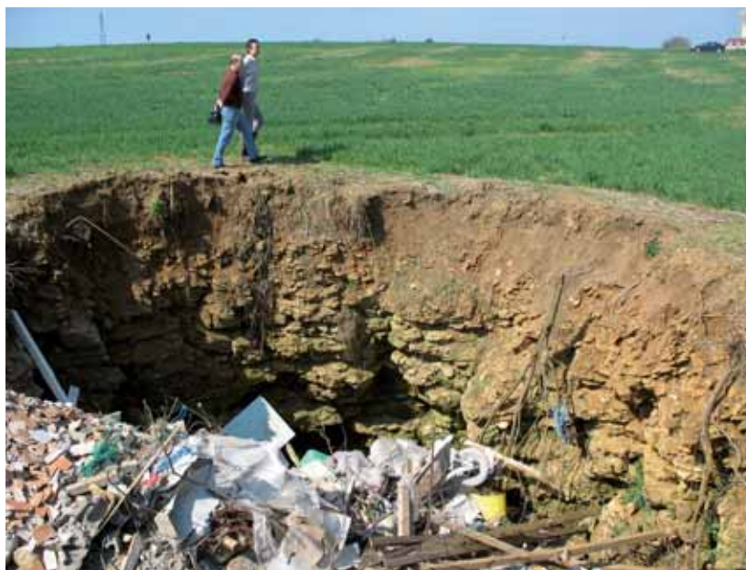
Fig. 2-1 : Fontis récent au-dessus de vieilles chambres d'exploitation restées vides, dans une mine de fer de Lorraine : la nature ayant horreur du vide, les riverains s'empressent souvent de l'utiliser comme décharge sauvage (photo E. Equilbey, Brgm)
