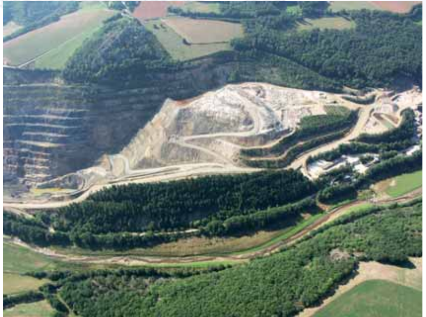
Fig. 2-23 : Comblement « marchant » (= au fur et à mesure) et revégétalisation des gradins supérieurs de la mine de fluorine à ciel ouvert de Montroc (Tarn) et sa laverie à droite (photo P. Bretin 2001, SOGEREM/ALCAN).
