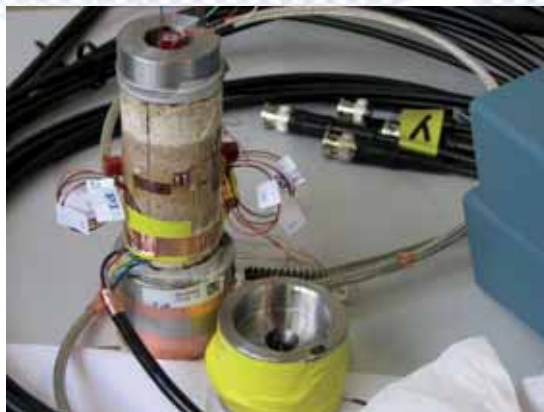
Fig. 3-10 : Epreuve de roche équipée de capteurs acoustiques (étude en laboratoire du comportement mécanique des roches du bassin ferrifère lorrain) photo ENSG / LAEGO.
