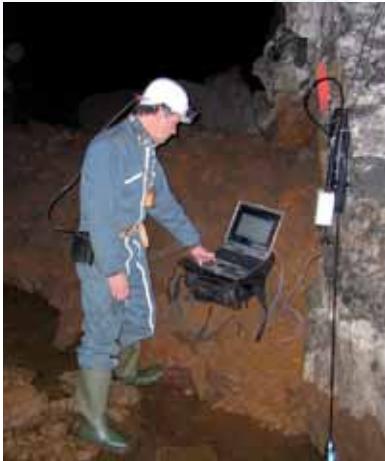
Fig. 3-12 : Mesure de la qualité de l'eau autour du remblayage d'une cavité minière (mine de fer de Tiercelet, Lorraine), photo Brgm.
