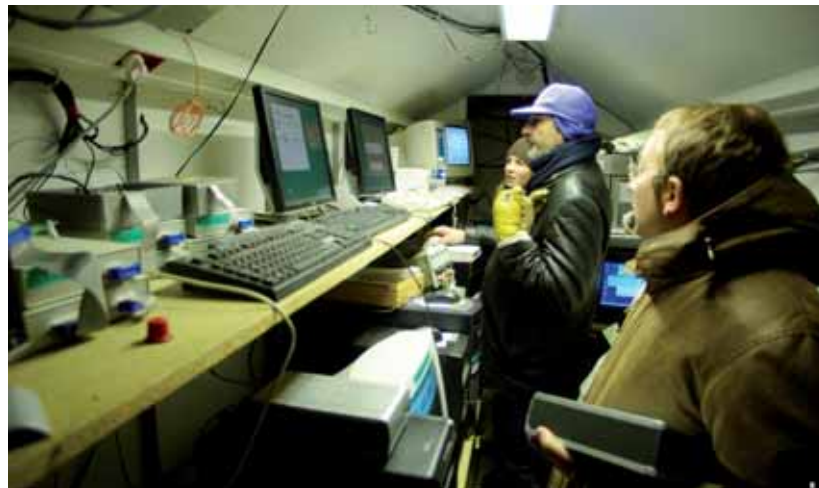
Fig. 3-14 : Station d'acquisition de données géophysiques pour le suivi de l'effondrement provoqué d'une cavité de dissolution dans le sel en Lorraine (concession Solvay), photo Brgm.
