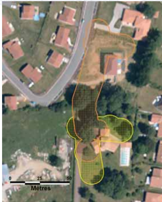
Fig. 3-6 : Extrait d'une cartographie d'aléas de mouvements de terrain réalisée à l'aplomb d'une couche horizontale de minerai exploitée à moins de 50 m de profondeur ; les couleurs indiquent (en surface) deux degrés d'intensité de l'aléa d'effondrement localisé, dont l'origine serait des galeries (éléments linéaires) et des puits (éléments circulaires) ; doc. Brgm-GEODERIS.
