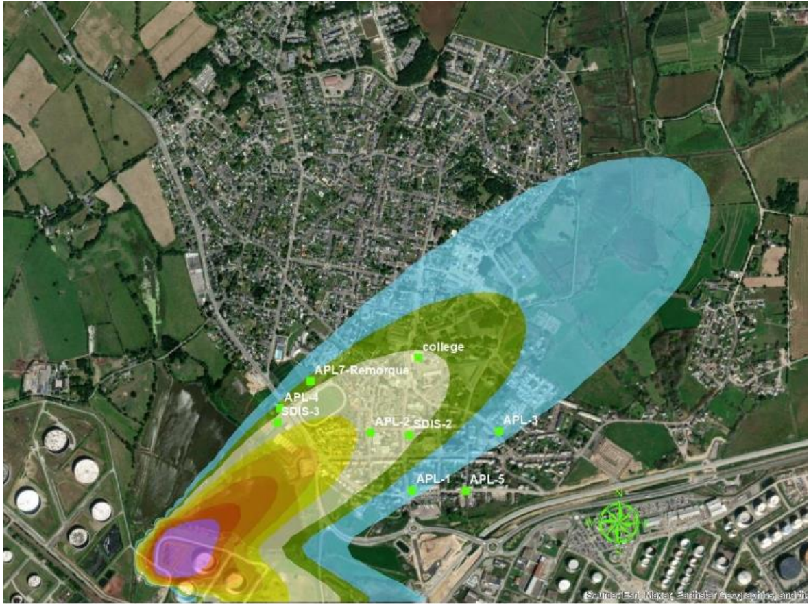
BENZENE ( \mu\text{g}/\text{m}^3 ) Concentration moyenne J05 End METEO Rugo variable (raf 0.2 / ville 0.3) Vent raff mini 1 ms-1
