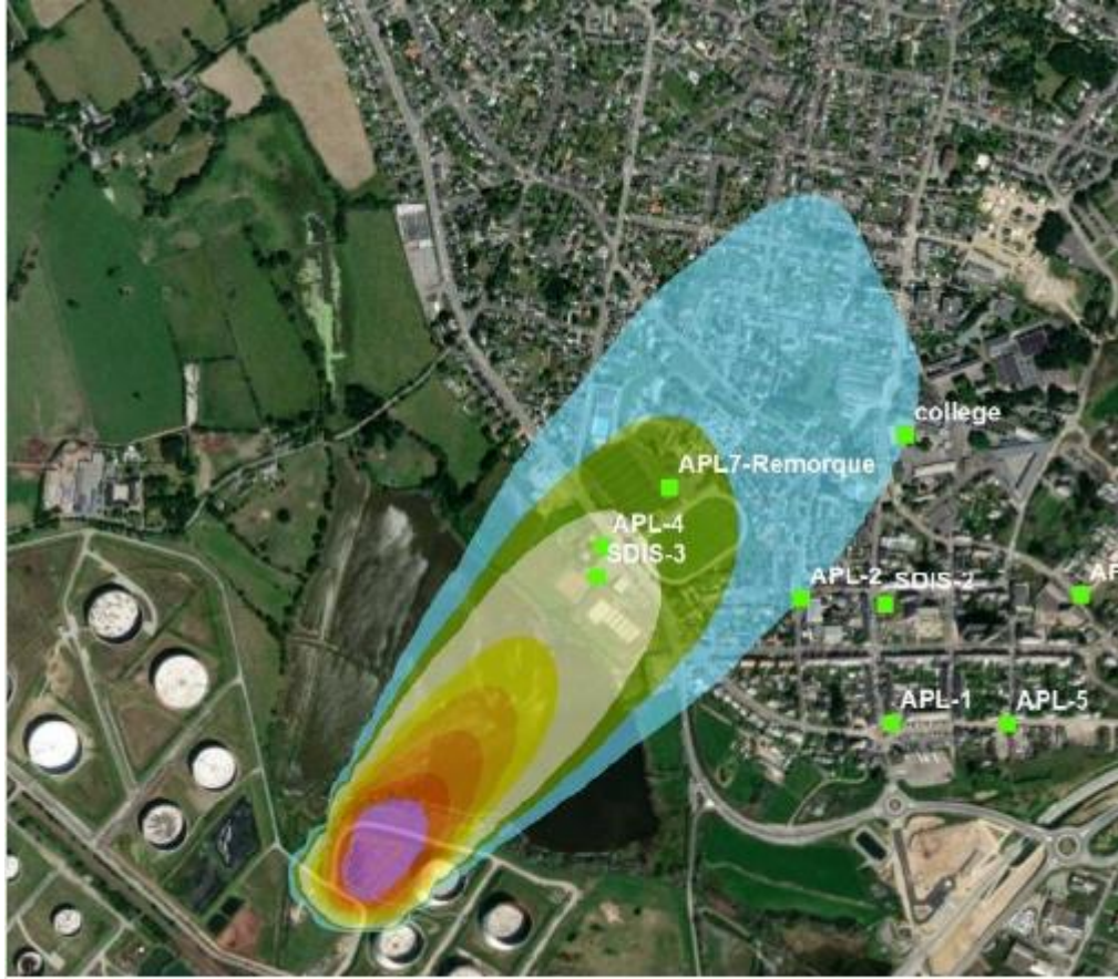
BENZENE ( \mu\text{g}/\text{m}^3 ) Concentration moyenne J07 End METEO Rugo variable (raf 0.2 / ville 0.3) Vent raff mini 1 ms-1
