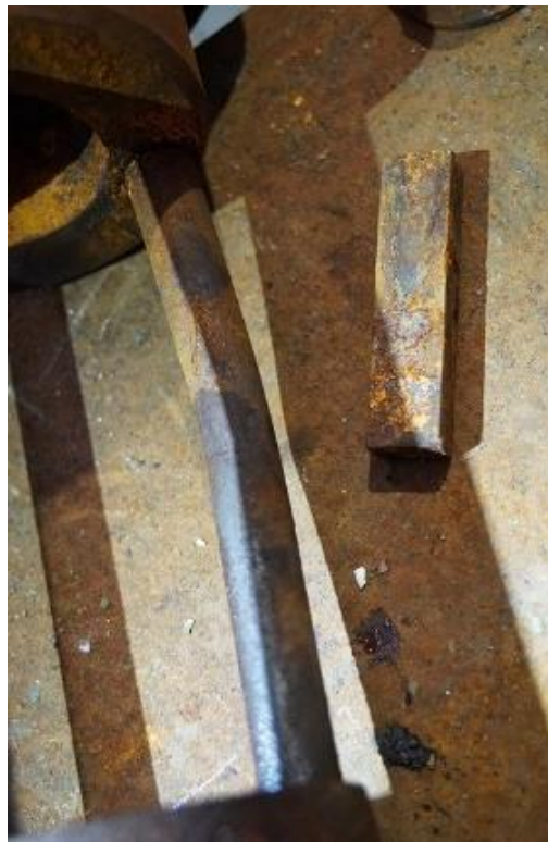
Figure 15 : déformation d'une des colonnes
